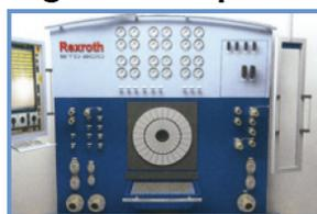
Slouží ke statické – dynamické a životnostnímu testování širokého výkonového spektra regulačních čerpadel a hydromotorů při globálním – mezinárodním sběru a předávání dat.
